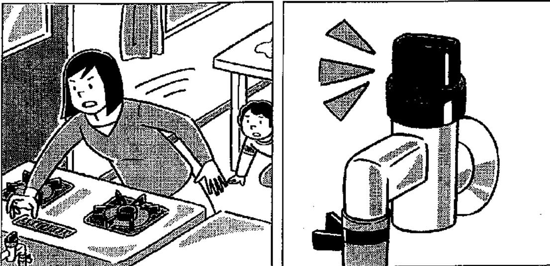
かつては「グラッと来たら火の始末」といわれていましたが、現在では大きな揺れを感じると、自動的に止まるガスコンロやガスマーターが一般的になっています。復旧後のガス漏れ事故を防ぐためにも、揺れが収またら、忘れずに元栓を閉めましょう。
